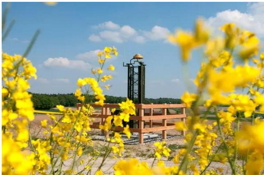
La rete di misurazione di precisione satellitare "NaGNet" è l'acronimo di "Nagra's permanent GNSS Network" ed è utilizzata per monitorare i minimi movimenti nel sottosuolo geologico. Le stazioni di misura registreranno per decenni dati di posizione molto precisi dal sistema globale di navigazione satellitare (GNSS).
