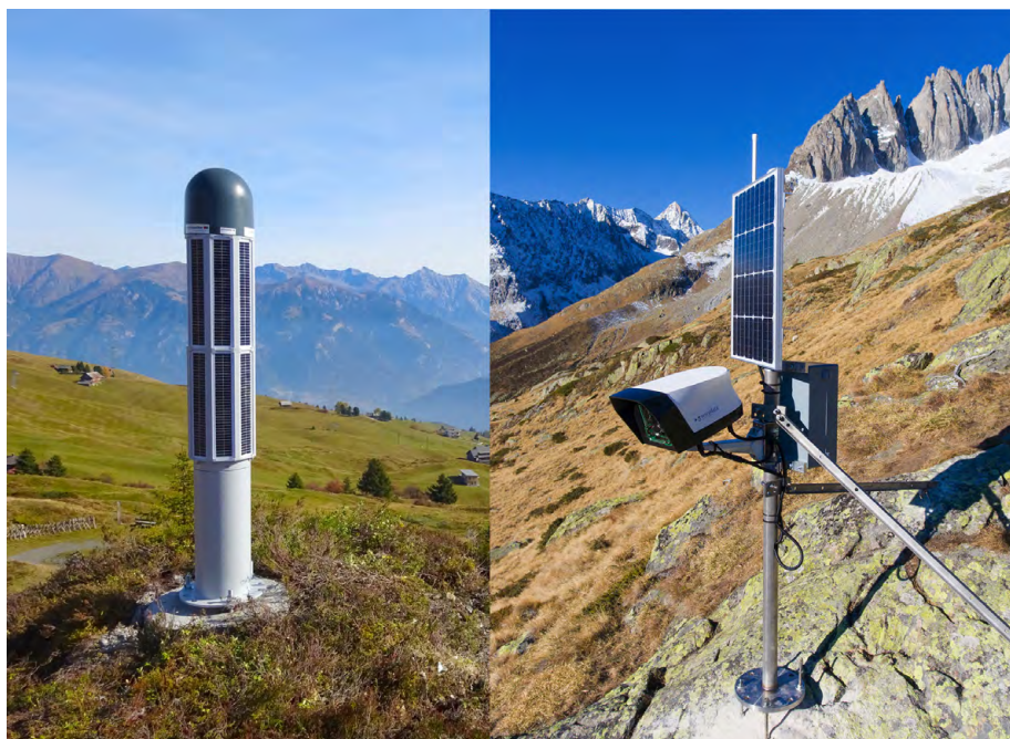
Abb. 1: Robuste GNSS-Station (links) und Kamerastation (rechts). Beide Stationen sind für den alpinen Einsatz konzipiert und arbeiten autonom.
