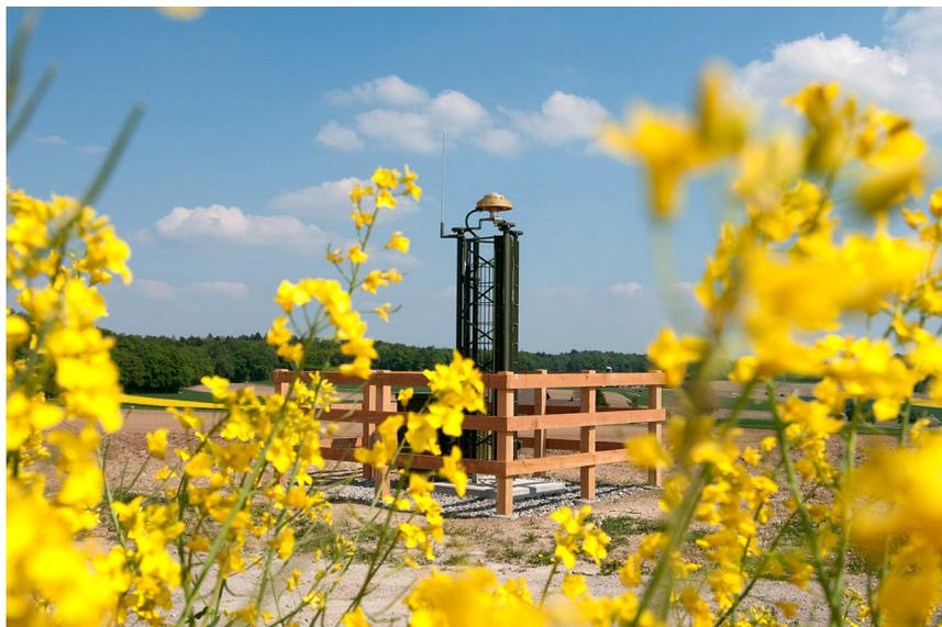
Das satellitengestützte Präzisionsmessnetz «NaGNet» steht für «Nagra's permanentes GNSS Network» und dient der Beobachtung geringster Bewegungen im geologischen Untergrund. Die Messstationen zeichnen über die nächsten Jahrzehnte hochgenaue Positionsdaten des «Global Navigation Satellite System» (GNSS) auf.
