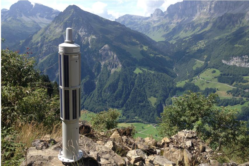
Mit 5 autarken, solarbetriebenen Einfrequenz-GNSS-Stationen werden in einem Rutschgebiet in der Gemeinde Glarus Süd in den Schweizer Voralpen die Bewegungsgeschwindigkeiten und -richtungen langfristig überwacht.
