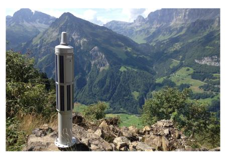
Mit 5 autarken, solarbetriebenen Einfrequenz-GNSS-Stationen werden in einem Rutschgebiet in der Gemeinde Glarus Süd in den Schweizer Voralpen die Bewegungsgeschwindigkeiten und -richtungen langfristig überwacht.
